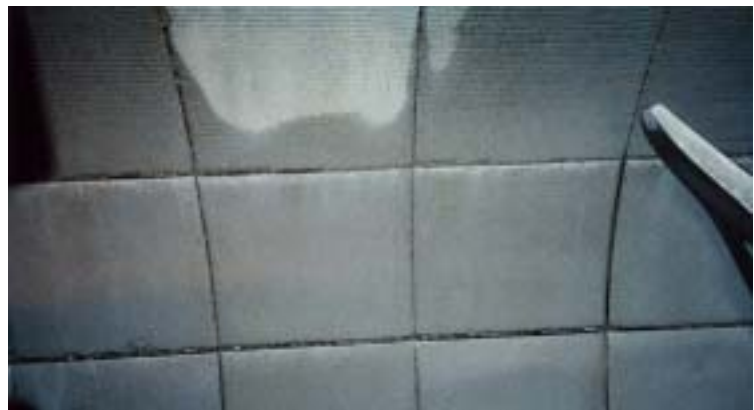
某ダムバッチャープラント(2軸強制攪拌) 混練量 75,000 m 3 での外観 (従来高クロム系耐用度 17,000~25,000 m 3 )
